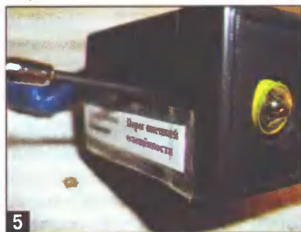
5 Регулировка порога освещенности.
