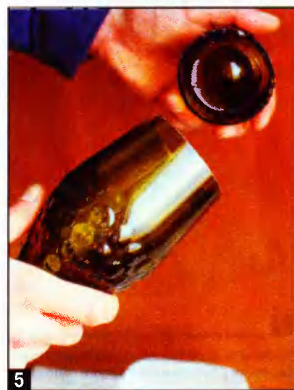
Если все сделано правильно, то доньшко отделяется от бутылки точно по намеченной стеклорезом линии.
