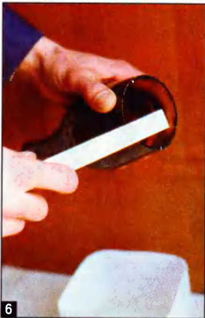
6 Острые края реза нужно притупить абразивным бруском.
